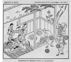
San-kai-me-i-but-su-dzu-yé. Vol. I, Tab. 7. Bocardage du minerai avant la calcination. 山海名物図会 1 卷 7 図. 焙焼前に鉱石を砕く[ハク(鉛)石くだく絵]
