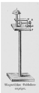
Magnetischer Erdbeben-anzeiger. 磁気地震予報装置
