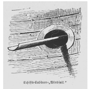
Schiffs-Cabinen-"Windsail". 船室の「ウインドスル」[船内へ外気を導く帆布製の通風筒]
