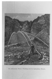
Ein californischer Mineur; Waschung nach der hydraulischen Methode. カリフォルニアの坑内夫; 水力を用いる方法による洗鉱
