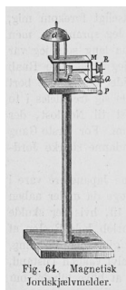
Fig. 64. Magnetisk Jordskjælmelder.
