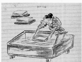
The "boat": length 6 feet; breadth 3 feet. "漉き舟": 長さ6フィート; 幅 3フィート
