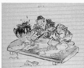
Removing the inner fibre. 内側の繊維[白皮]を取り外す
