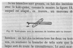
Kaki-gama avec le morceau de bambou mis en travers. 横に抜ける竹の断片のついた搔鎌[竹をはめたる搔鎌]
